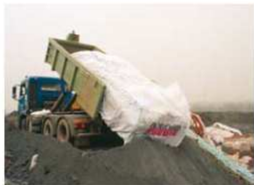
Stap 6: Hierna is de container klaar voor transport en kan de containerliner op de stortplaats gelost worden.
