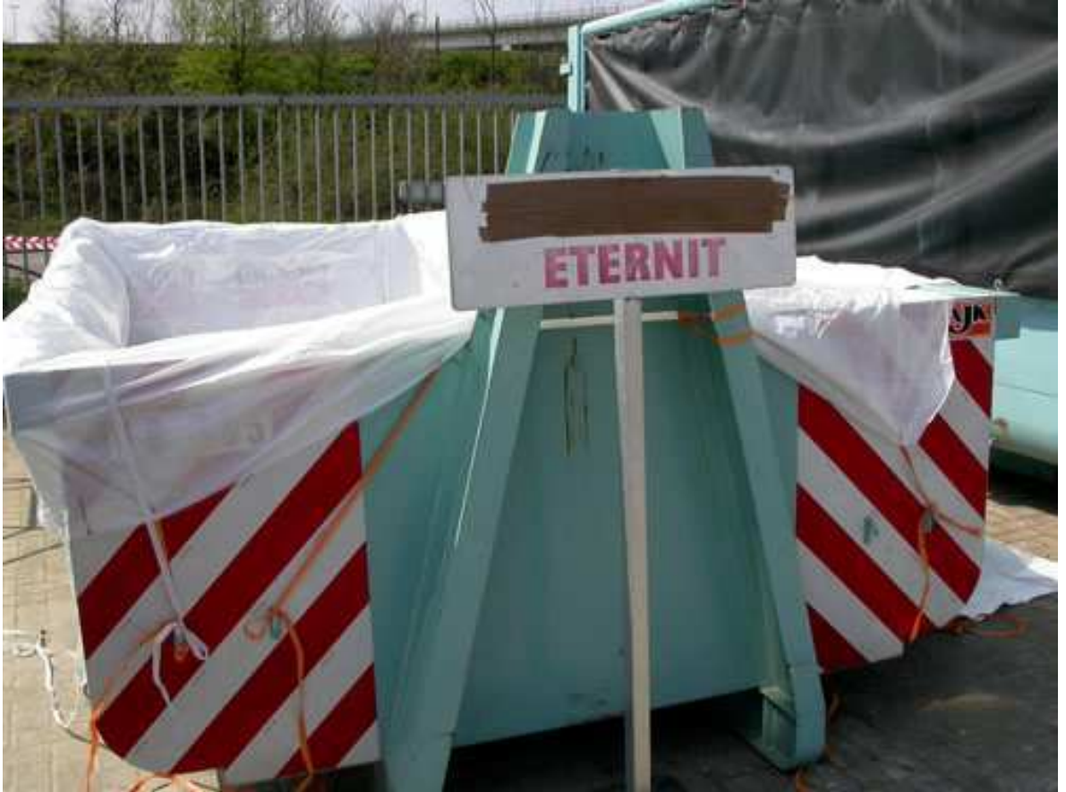
Figuur 4 Open container met container big bag voor de inzameling van hechtgebonden asbesthoudende afvalstoffen op een Vlaams containerpark
