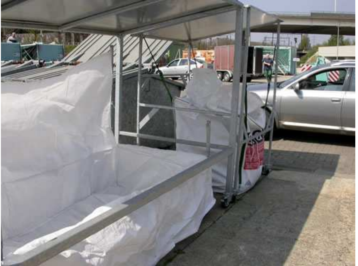
Figuur 2 Opstelling van een platenzak (links) en een big bag (rechts) voor de inzameling van hechtgebonden asbesthoudende afvalstoffen op een Vlaams containerpark
